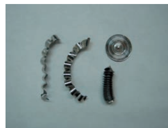
スーパーUドリル -LMブレーカによる切りくず
